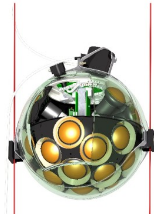
სურათი 2.14. მარცხნივ ოპტიკური მოდულის ფოტო. მარჯვნივ დეტექციის ერთეულზე დამონტაჟებული ოპტიკური მოდულის კომპიუტერული გრაფიკული სურათი
