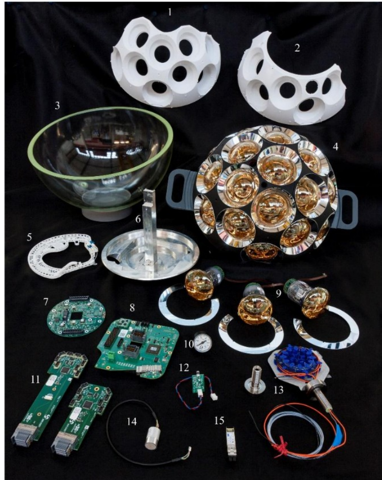
სურათი 2.15. KM3NeT ოპტიკურ მოდულის შემადგენელი კომპონენტები
