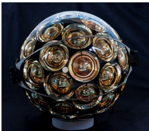
სურათი 2.14. მარცხნივ ოპტიკური მოდულის ფოტო. მარჯვნივ დეტექციის ერთეულზე დამონტაჟებული ოპტიკური მოდულის კომპიუტერული გრაფიკული სურათი
